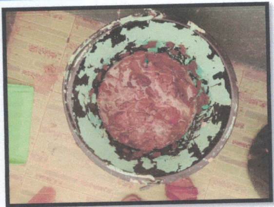
นำกระดาษลังที่เตรียมไว้แช่ในน้ำผสม โซดาไฟเพื่อให้เปื่อยยุ่ยเร็ว
